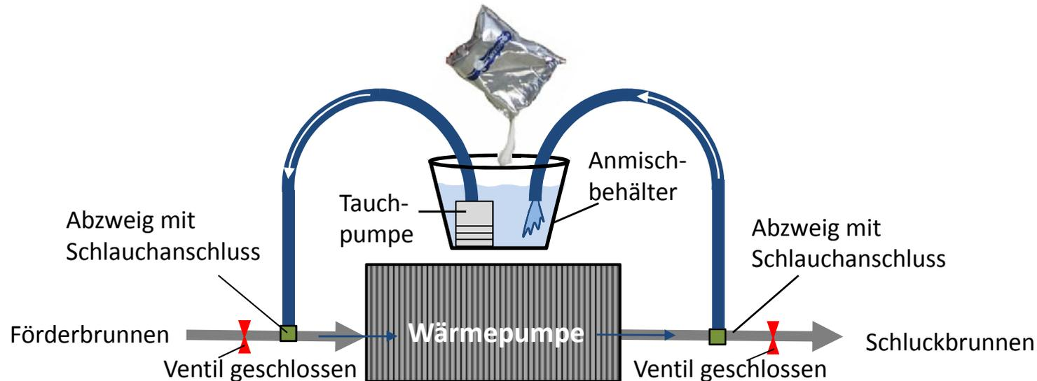
In einem Anmischbehälter mit 15-20 Liter Wasser wird das Reinigungsmittel (3 Beutel á 400 g) unter Rühren langsam aufgelöst.
